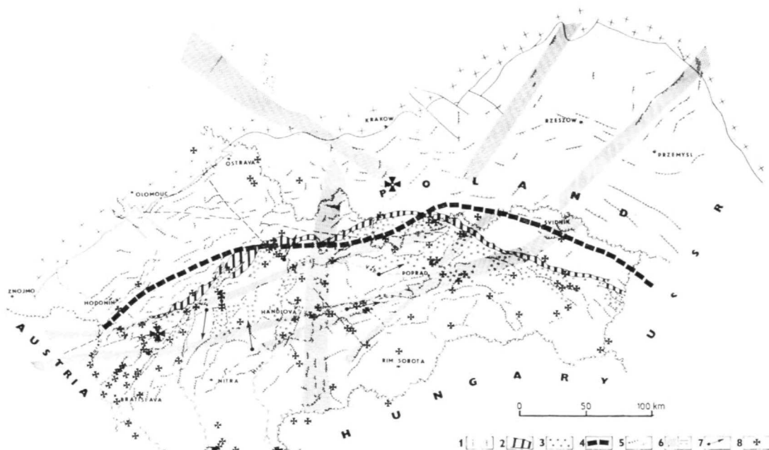
Obr. 3. Interpretovaná rozhraní a jejich vztah k hlavním geofyzikálním anomaliím. 1 — platforma, 2 — bradlové pásmo, 3 — rozšíření vnitrokarpatského paleogénu, 4 — vodivostní rozhraní v kůře, 5 — hustotní rozhraní (podle tíhových údajů), 6 — rozhraní interpretovaná na základě DPZ, 7 — směry paleodeklinací pro horniny staršího paleozoika, 8 — ohniska zemětřesení (podle Pospíšila — Schenka — Schenkové, v tisku)
